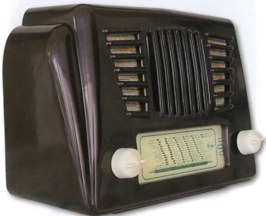
Mono Unda n°51/2, Anie, 1951-1952, ricevitore a 5 valvole racchiuso in mobile di bachelite di piccole dimensioni (29 x 20 x 15 cm)
